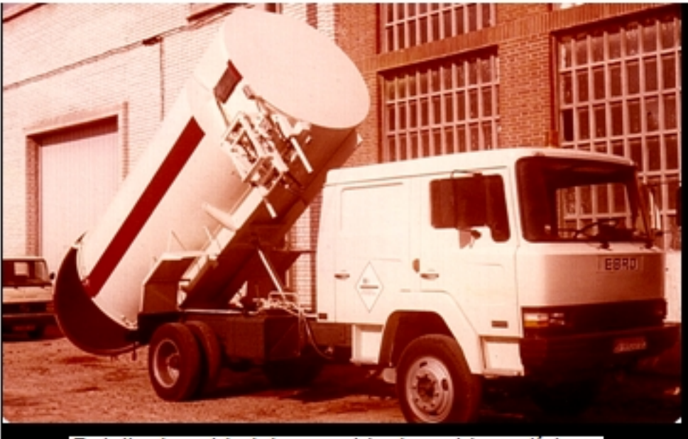
Detalle de unidad de recogida de residuos clínicos
